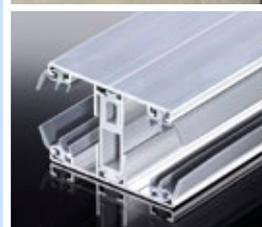
Zur Verlegung der Platten empfehlen wir Ihnen unser thermisch getrenntes Aluprofil (Preisliste siehe S. 20 + 21). Das Thermosystem setzt sich aus einem Ober- und Unterprofil, sowie PVC-Distanzleisten zusammen inkl. eingezogenen Lippendichtungen.
